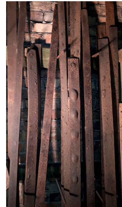
Till vänster: Brännstålsugn eldstad. Till höger: Brännstålsstänger med blåsor, benämns även blåsstål. De står uppställda inne i den röda byggnaden som innehåller brännstålsugnarna. Foto: Claes Gille.
